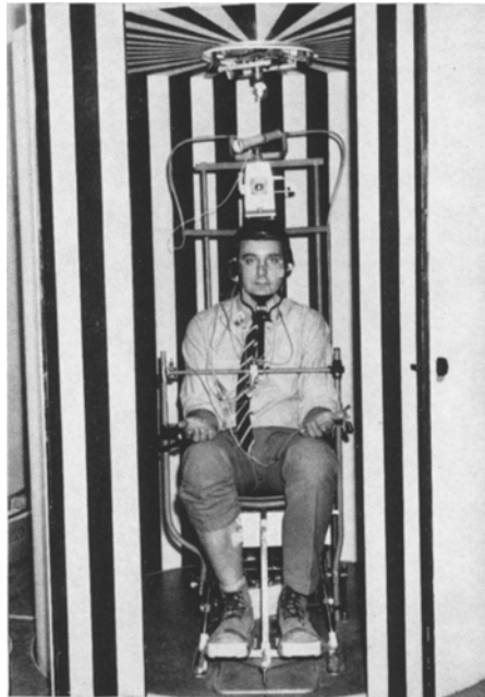
Abb. 1. Drehstuhl-Drehtrommeleinheit mit Versuchsperson
